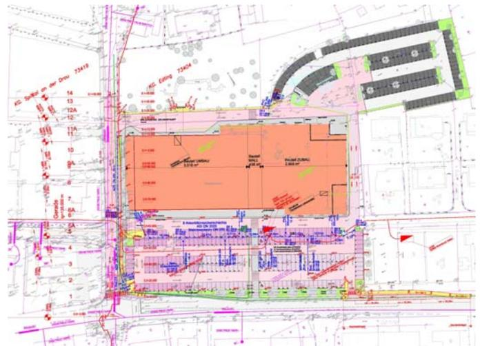
Es war vorgesehen, den bestehenden Parkplatz Süd entsprechend den Umbauplänen für das Gebäude zu erweitern und die Anbindung zur Edlingerstraße entsprechend nach Norden zu verschieben. Der südöstliche Teil des Parkplatzes sollte mittels einer Deckensanierung instandgesetzt werden. Im westlichen Bereich zur Edlingerstraße war der Parkplatz höhenmäßig an die neuen Gegebenheiten anzupassen, somit war ein kompletter Neubau des Straßenkörpers notwendig.
