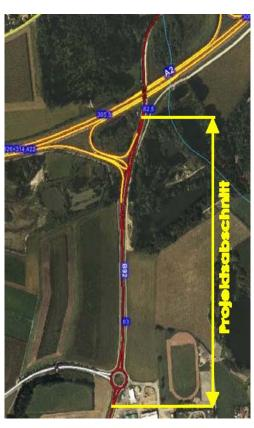
Für das vorliegende Projekt war ein Sicherheitsaudit mit Prüfbericht auf Grundlage der ESAS und der RVS vom Verfasser durchzuführen. Das Audit umfasste den Kreisverkehr im Bereich der Anschlussstelle, die Kreuzung B92/Pischeldorfer Straße/Ernst-Diez-Straße sowie den vierstreifigen Ausbau der B92 Görtschitztal Straße.
